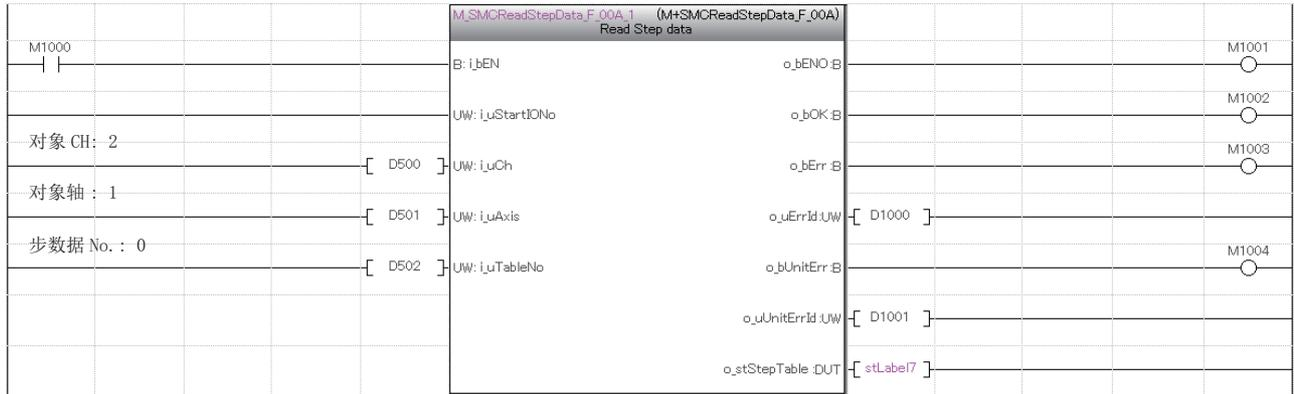
通过将M1005设为ON, 将结构体类型(stStepData)的本地标签stLabel17的数据存储至数据寄存器(D)的示例如下所示。
