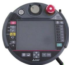
プログラムの作成・修正・管理や動作位置の教示、ジョグ送りなどをおこないます。この高機能版ティーチングボックスは、タッチパネルを使ったグラフィカルユーザインタフェース (GUI) を備えていますので、操作を簡単におこなうことができます。また、安全にご使用いただくため、3ポジションイネーブルスイッチ※1) を装備しています。ロボットが複数台ある場合、1台のティーチングボックスをつなぎ換えてご使用できます。ただし、電源を遮断した状態でつなぎ換えます。
