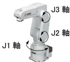
J1 軸、J2 軸、または J3 軸の動作範囲をロボット本体の機械的ストップと、コントローラのパラメータで制限するものです。
