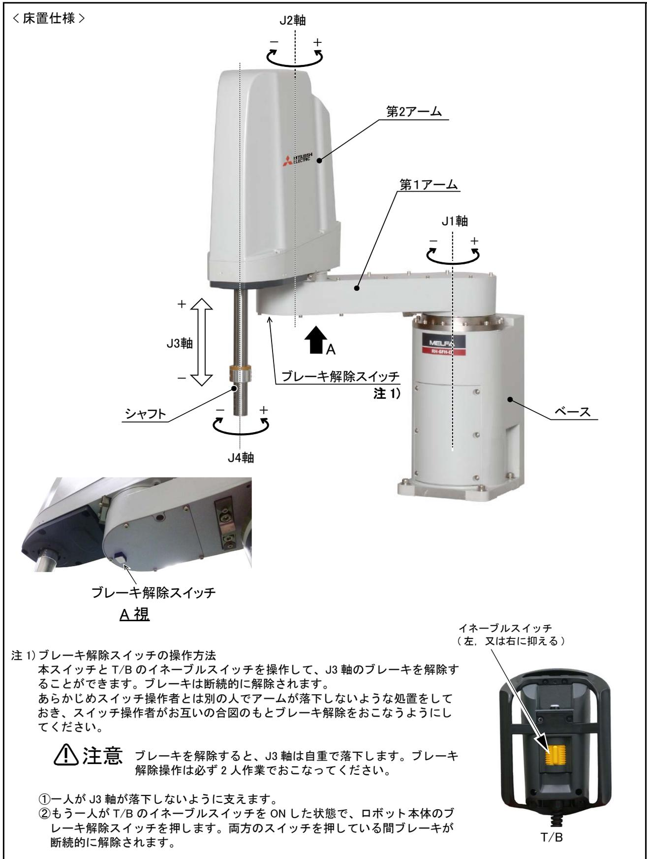
図 2-16 : ロボット本体各部の名称 (床置仕様)
