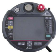
プログラムの作成・修正・管理や動作位置の教示、ジョグ送りなどをおこないます。この高機能版ティーチングボックスは、タッチパネルを使ったグラフィカルユーザインタフェース (GUI) を備えていますので、操作を簡単におこなうことができます。また、安全にご使用いただくため、3 ポジションイネーブルスイッチ<sup>※1)</sup>を装備しています。ロボットが複数台ある場合、1 台のティーチングボックスをつなぎ換えてご使用できます。ただし、電源を遮断した状態でつなぎ換えます。
