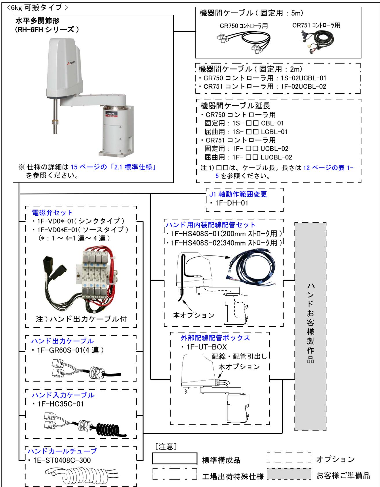
図 1-1 : 構成機器の概要 (RH-6FH シリーズ)
